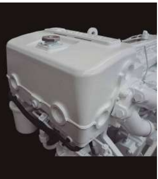
Intercambiador abierto agua-agua
