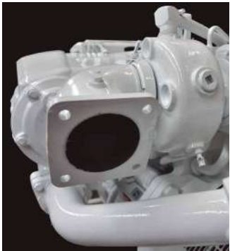
Turbo refrigerado por agua
