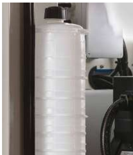
Depósito de agua destilada
