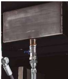
Depósito de aceite para rellenado automático
